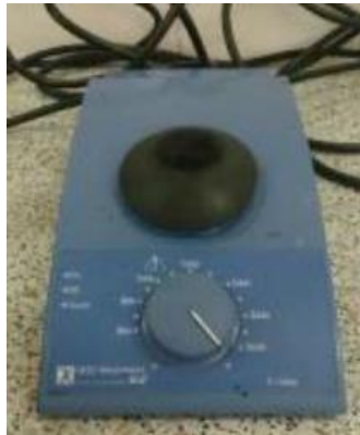
Slika 3.3 Homogenizator MS2 Minishaker IKA
