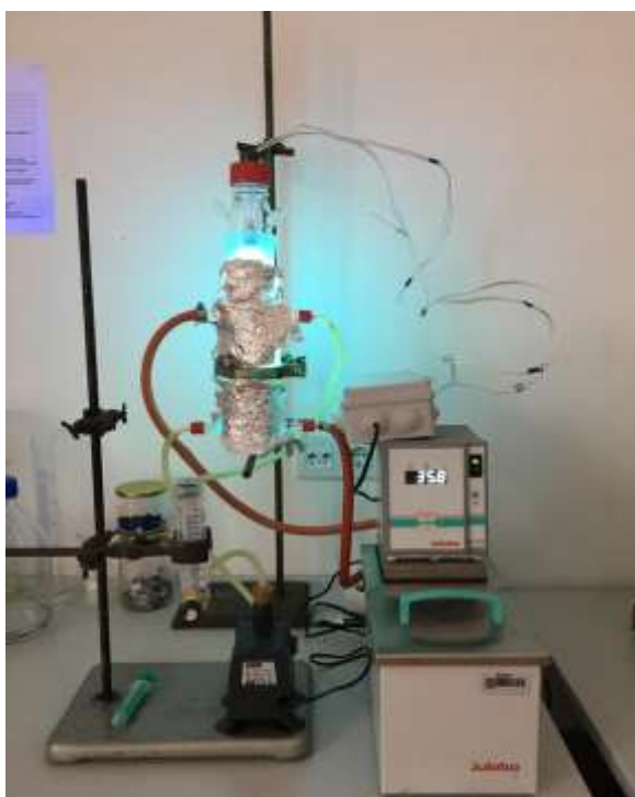
Slika 3.1. Izvedba fotoreaktora anularnog tipa sa recirkulacijom reakcijske smjese
