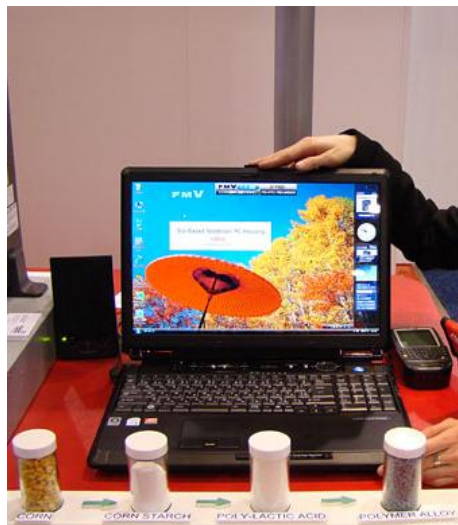
Slika 29. Kućište kompjutera od PLA [23]
