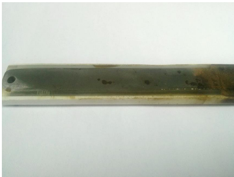
Slika 17. Dio katodno zaštićene čelične pločice koji se nalazio na zraku.
