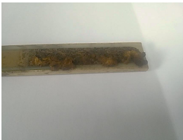
Slika 22. Dio kontrolne čelične pločice koji se nalazio u vodenoj fazi.
