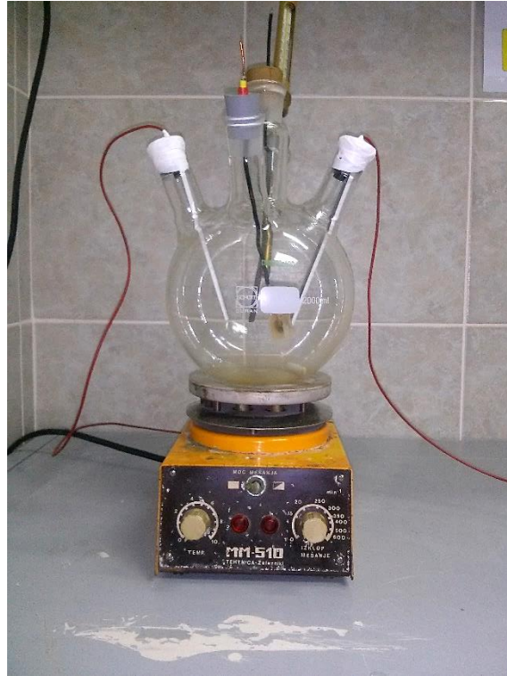
Slika 5. Prazna aparatura postavljena na magnetsku miješalicu s grijačem.
