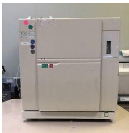
Slika 3.4.2. Instrument za analizu ukupnog organskog ugljika, Shimadzu TOC-V CPN
