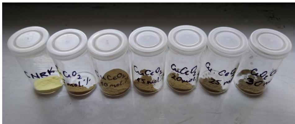
Slika 6. Uzorci čistog i bakrom dopiranog CeO<sub>2</sub> dobiveni hidrotermalnom sintezom. Molarni udio bakra u uzorku raste s lijeva na desno.
