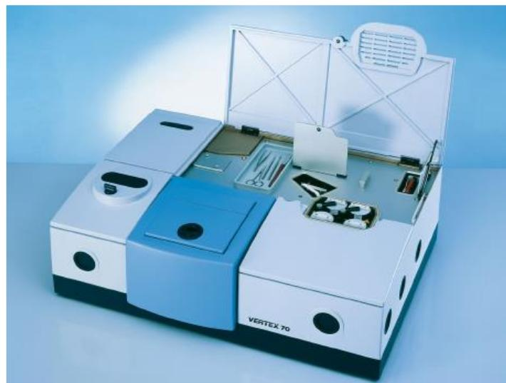
Slika 5. Infracrveni spektrometar s Fourierovom transformacijom (FTIR) Bruker Vertex 70 [18].
