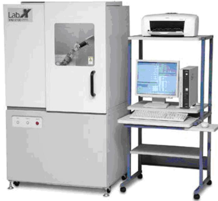
Slika 7. Rendgenski difraktometar Simadzu XRD 6000 [14].
