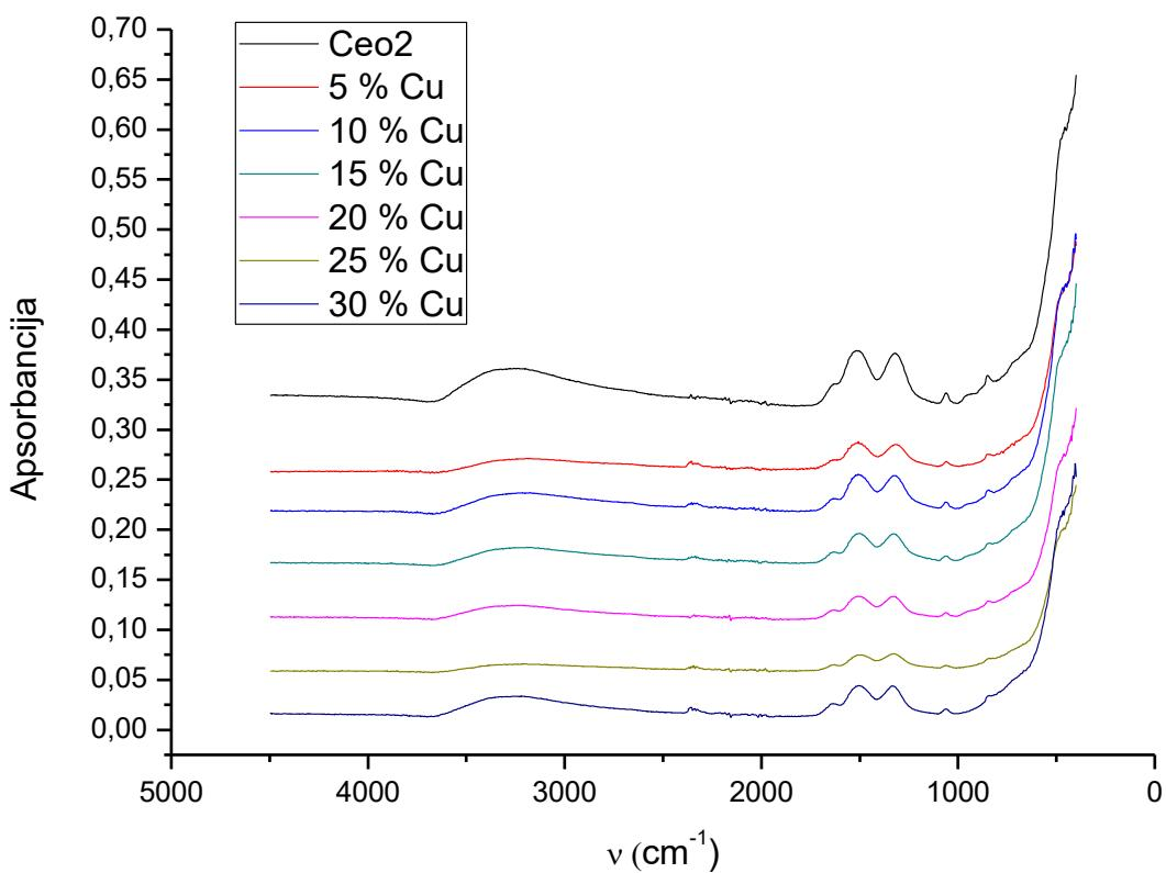
Slika 8. Spektrogrami dobiveni infracrvenom spektroskopijom s Fourierovom transformacijom uzorka bakrom dopiranog  $\text{CeO}_2$  te čistog  $\text{CeO}_2$ .
