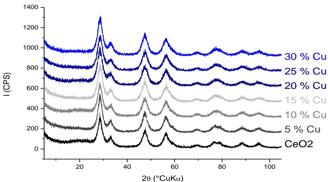
Slika 7. Difraktogrami dobiveni XRD analizom uzoraka CeO<sub>2</sub> dopiranih bakrom u molarnim udjelima 5, 10, 15, 20, 25 i 30 % te uzorka čistog CeO<sub>2</sub>.
