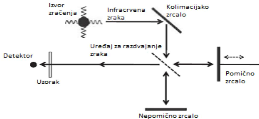
Slika 5. Shematski prikaz principa rada FTIR-a [17]
