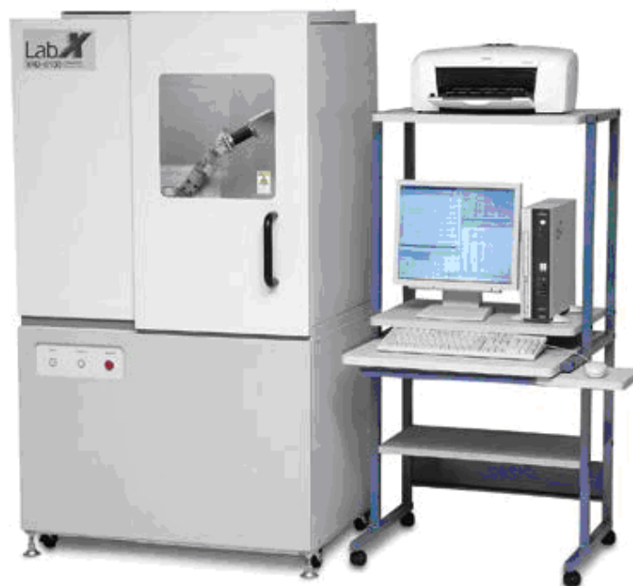
Slika 7. Rendgenski difraktometar Simadzu XRD 6000 [14].
