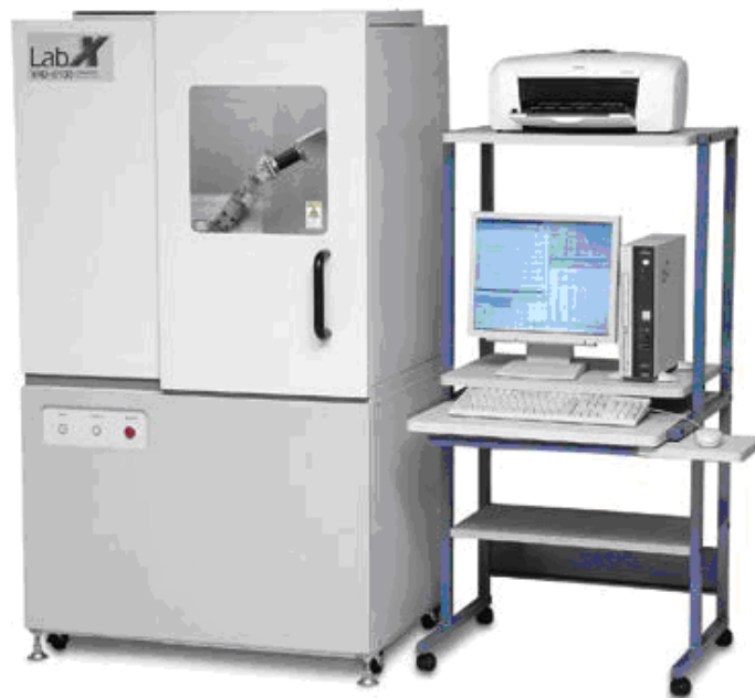
Slika 3.10. Fotografija uređaja za rendgensku difrakciju XRD 6000 (Shimadzu, Kyoto, Japan)
