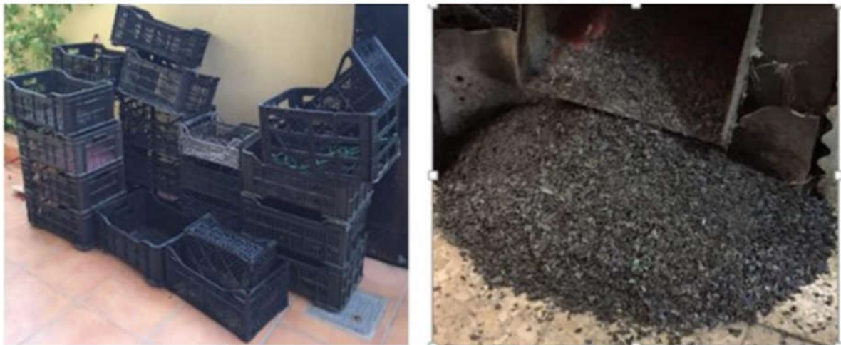
Slika 16. Otpadni polietilenski sanduci prije i poslije mljevenja [21]
