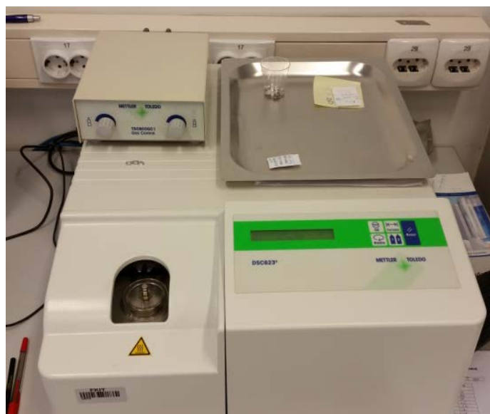
Slika 10. Fotografija diferencijalnog pretražnog kalorimetra Mettler Toledo 822° (Mettler Toledo, Columbus, Sjedinjene Američke Države)
