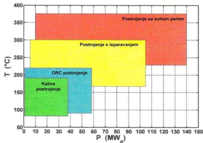
Slika 8. Područja primjene osnovnih tipova geotermalnih elektrana
