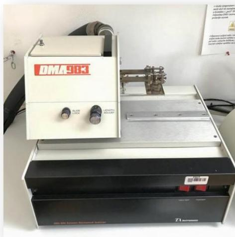
**Slika 14.** Dinamičko mehanički analizator DMA 983, TA instruments
