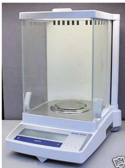
Slika 4. Analitička vaga Mettler Toledo, AB 104 [22]
