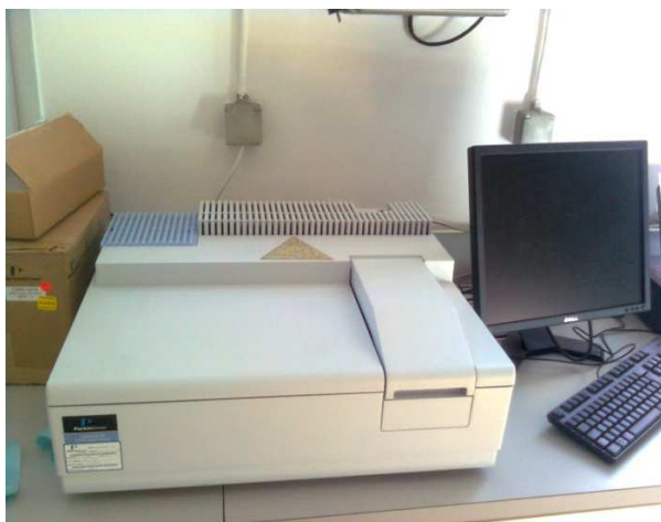
Slika 7. UV/VIS spektrofotometar PerkinElmer, Lambda 35, Waltham, Massachusetts, SAD [26]
