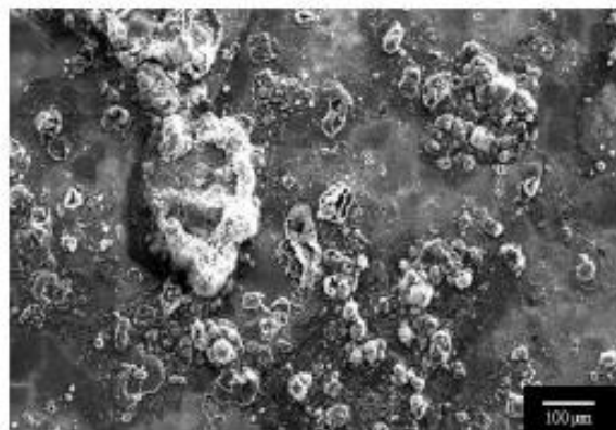
Slika 12. Morfologija korozijskih produkata na uzorku cinka pri 75 % relativne vlažnosti 11
