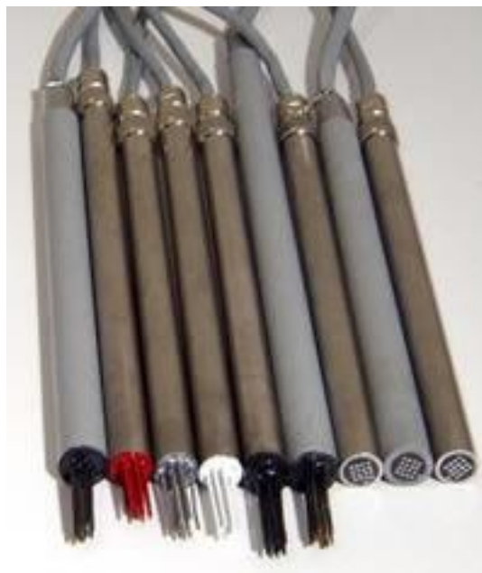
Slika 4. Prikaz CMS senzora 8
