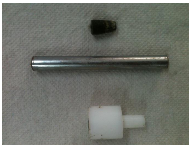
Slika 6. Bakreni valjkasti kalup
