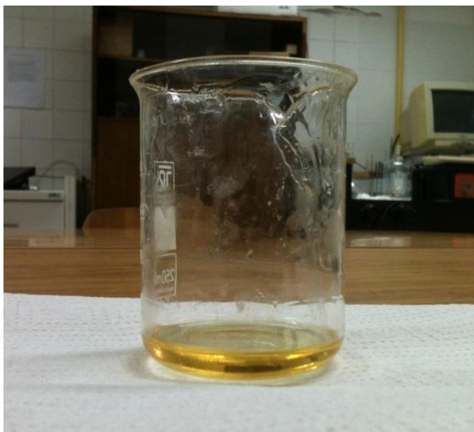
Slika 5. Smola pomiješana s inicijatorom
