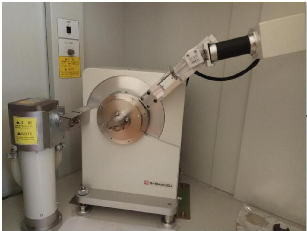
Slika 10: Korišteni uređaj za rendgensku difrakciju, XRD 6000 Shimadzu
