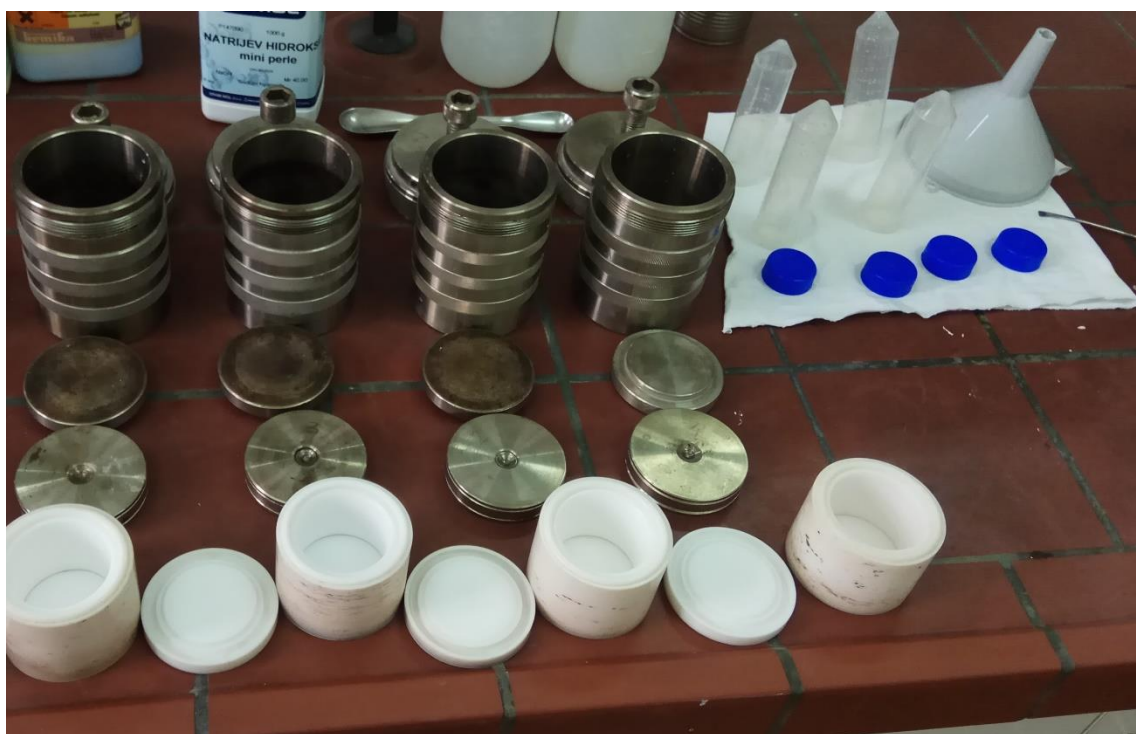
Slika 9: Korišteni autoklavi s teflonskim posudicama te kivete korištene prilikom postupka ispiranja produkta.
