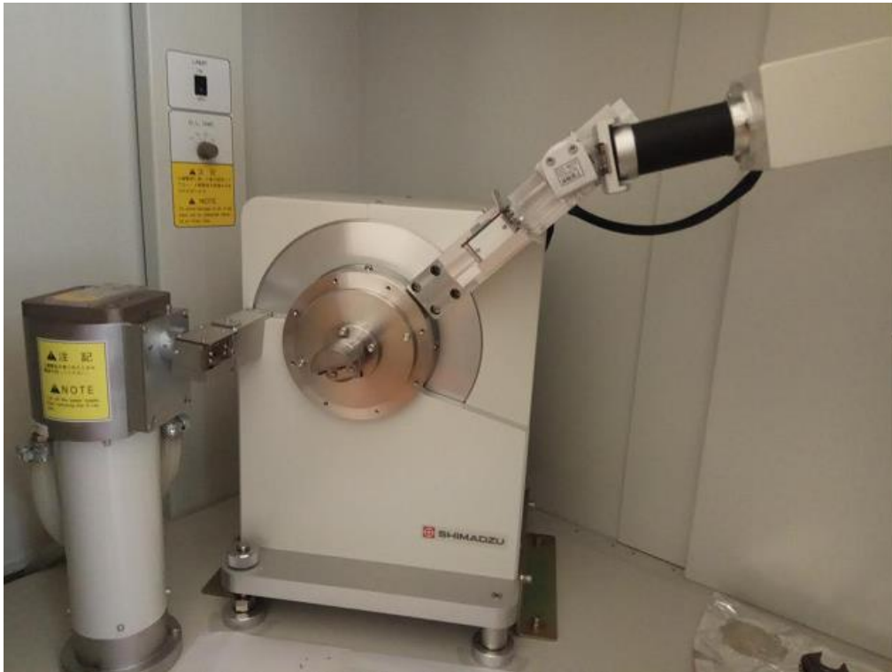
Slika 10: Korišteni uređaj za rendgensku difrakciju, XRD 6000 Shimadzu
