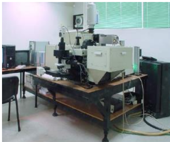
Slika 9. Ramanski sistem Horiba Jobin-Yvon T64000
