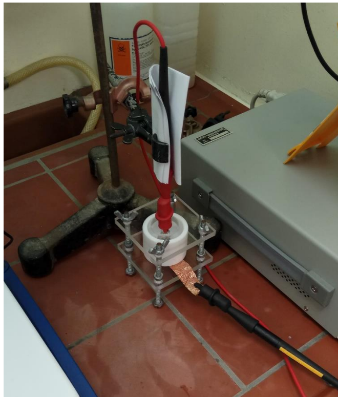
Slika 7. Prikaz aparature za anodizaciju
