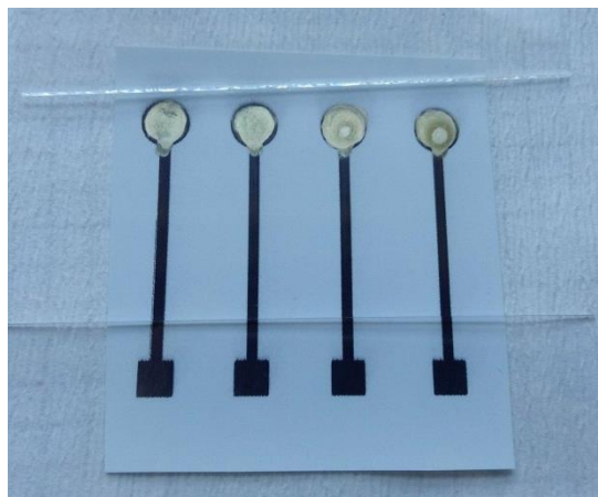
Slika 17. Ag printane elektrode nakon pripreme za modifikaciju.
