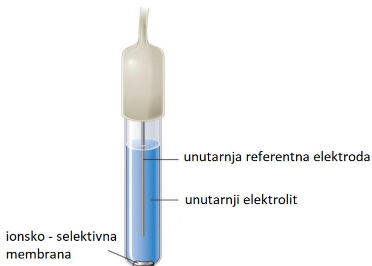
Slika 5. Ionsko – selektivna elektroda
