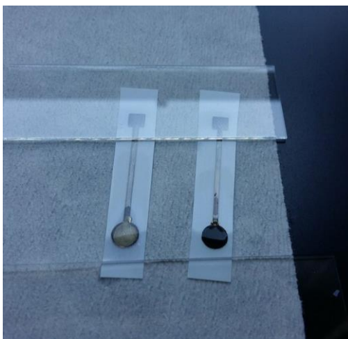
Slika 18. Ag|AgBr elektroda prije (lijevo) i nakon (desno) kemijske modifikacije.
