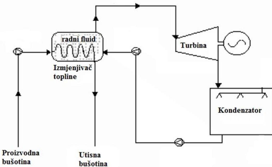
**Slika 11 - Shema postrojenja na geotermalnu energiju**
