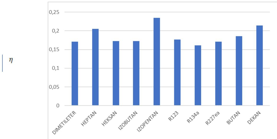
**Slika 46 – usporedba stupnja iskorištenja radnih tvari**
