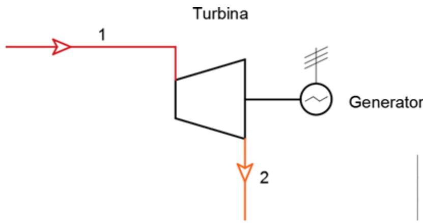
**Slika 17 – shematski prikaz turbine i generatora**
