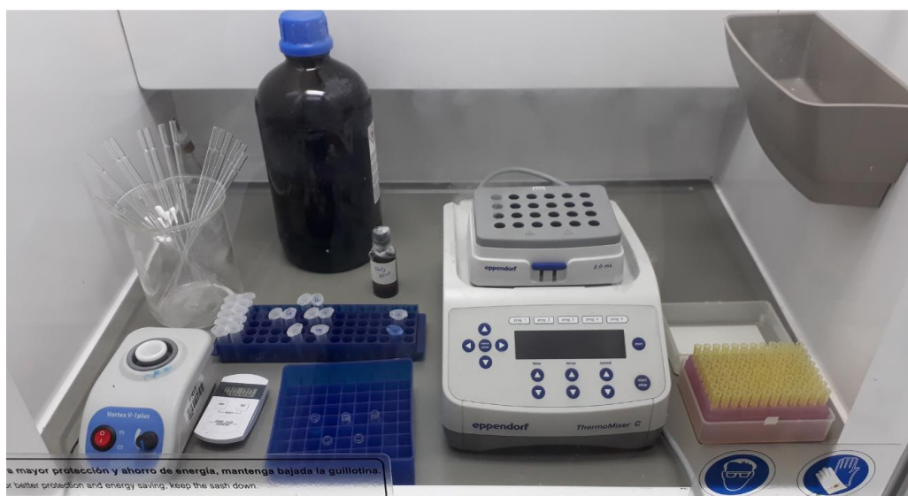
Slika 3.4. Ispitivanje kinetike s azidima u digestoru
