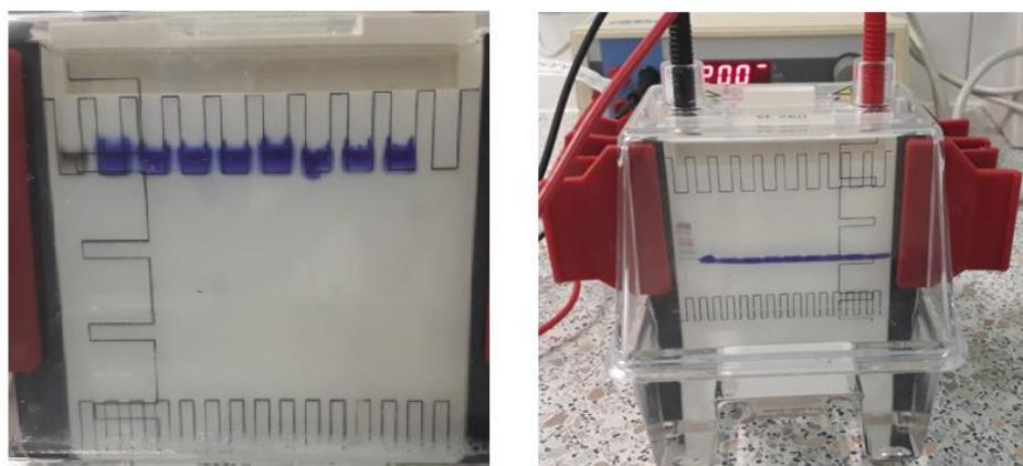
**Slika 3.1.** Lijevo: PA gel s nanesenim uzorcima neposredno prije početka elektroforeze;
