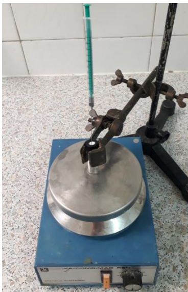
Slika 3.3. Reakcijski sustav za određivanje stabilnosti epoksida
