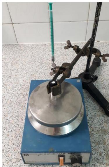
**Slika 3.3.** Reakcijski sustav za određivanje stabilnosti epoksida
