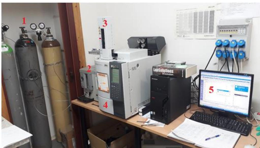
**Slika 3.5.** GC sustav: 1 – spremnici s plinovima, 2 – generator vodika, 3 – sustav za automatsko injektiranje, 4 – plinski kromatograf, 4 – računalna podrška
