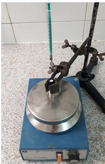
Slika 3.3. Reakcijski sustav za određivanje stabilnosti epoksida
