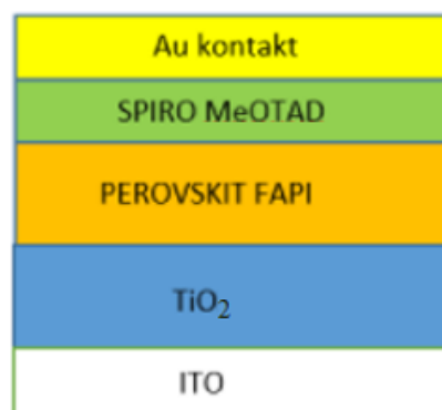
Slika 13. Shema slojeva solarne ćelije korištene u SCAPS simulaciji
