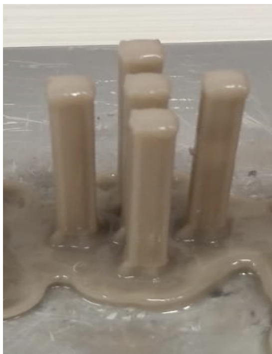
Slika 4.2. 3D-ispisani monoliti na radnoj podlozi 3D-pisača Form 2
