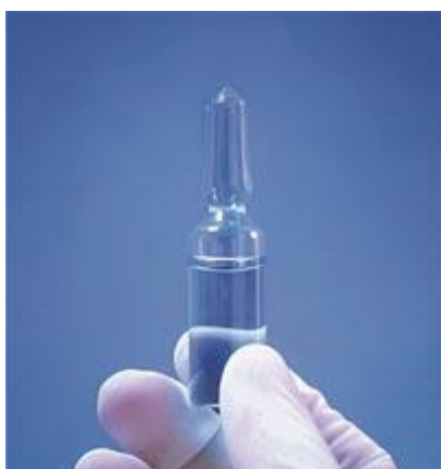
Slika 2. ETANOL-KLORBENZENSKI DOZIMETAR, ECB
