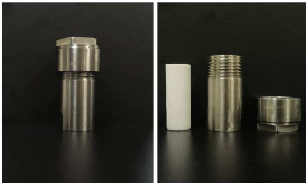
Slika 10. Moreyjev autoklav najčešće korišten za hidrotermalnu sintezu. [73]
