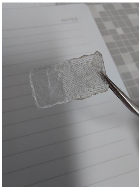
Slika 49. Pločica PVB-a nakon 10 minuta u acetonu
