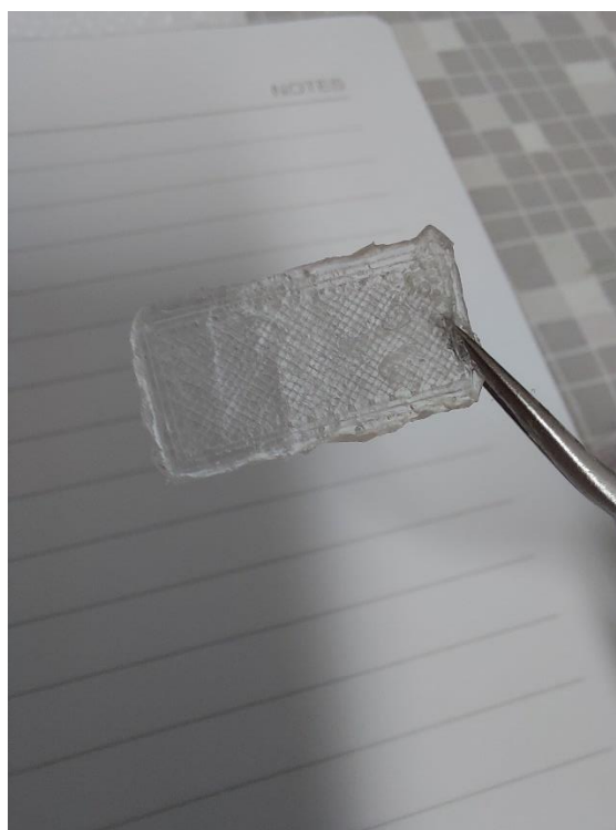
Slika 49. Pločica PVB-a nakon 10 minuta u acetonu
