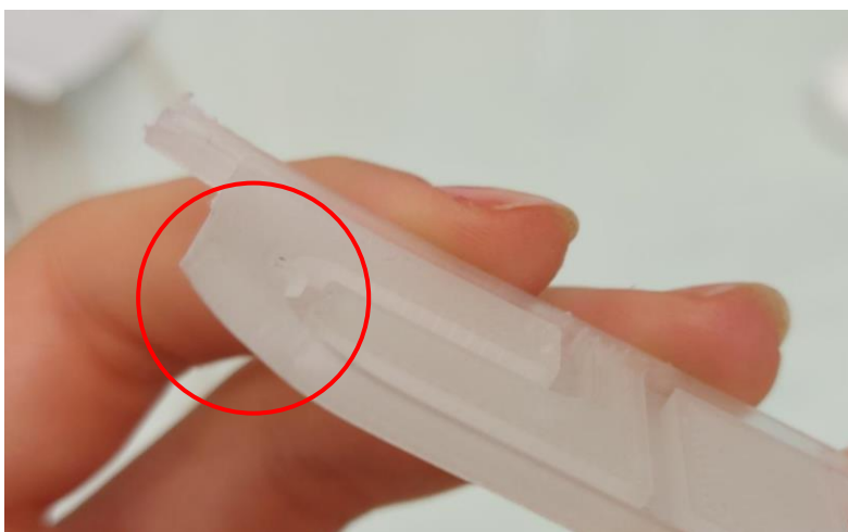
Slika 32. Pogreška u ispisu reaktora
