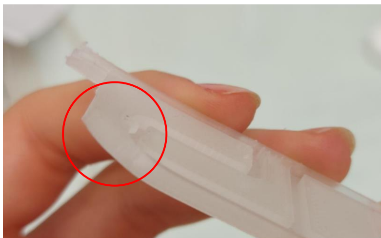
Slika 32. Pogreška u ispisu reaktora
