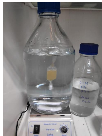
Slika 11. Dijaliza uzorka enzima lipaza TL u natrij-fosfatnom puferu pH 8,00
