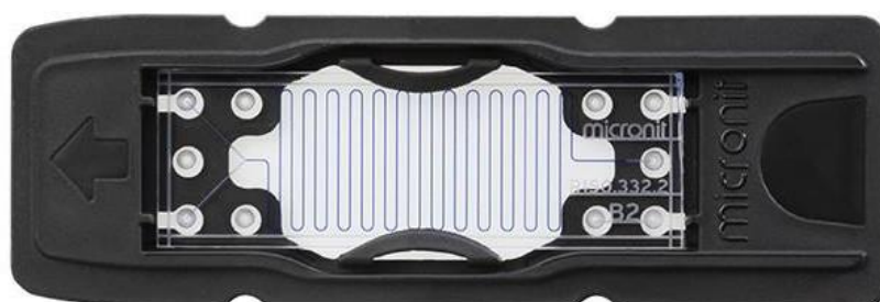
Slika 3. Mikroreaktor širine kanala 500 \mu\text{m} korišten u ovom radu
