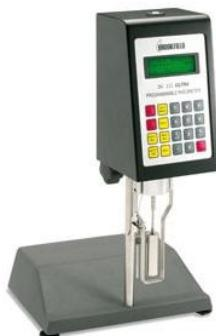
**Slika 14.** Rotacijski viskozimetar *Brookfield DV-III Ultra*
