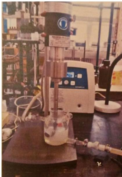
**Slika 12.** Oprema za raspršenje nanočestica
