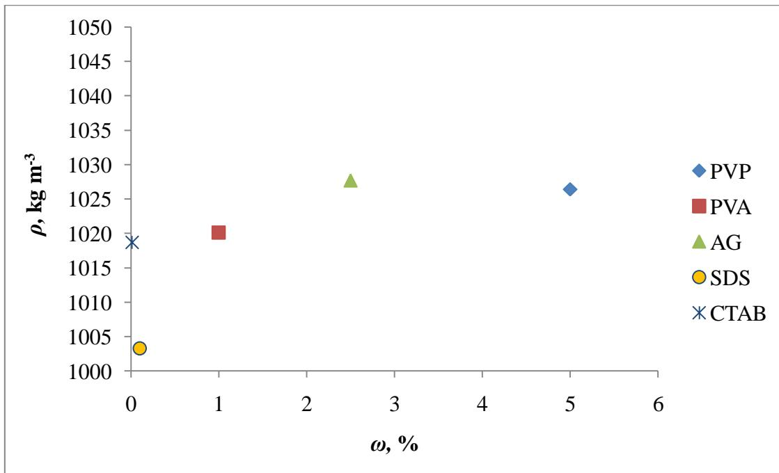
**Slika 26.** Promjena gustoće nanofluida (s dodanim aditivima) s masenim udjelom izmjerениh na sobnoj temperaturi
