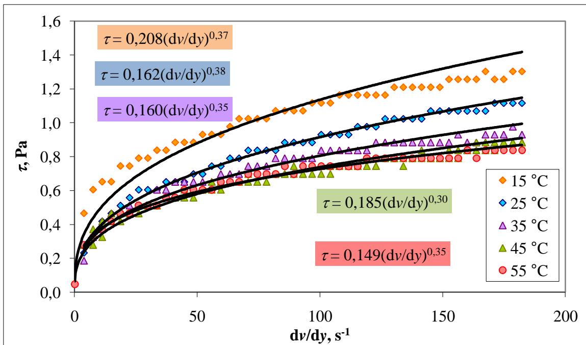
**Slika 23.** Promjena smičnog naprezanja sa smičnom brzinom –za 1M uzorak s dodatkom SDS (0.1 mas%).
