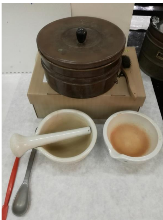
Slika 3.5. Sito za prosijavanje i tarionik s tučkom za usitnjavanje
