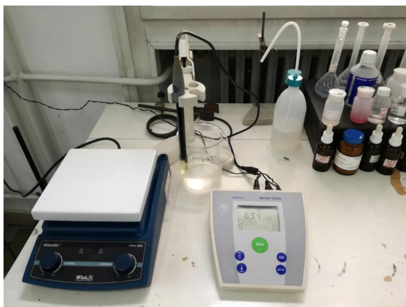
Slika 3.3. pH-metar Mettler Toledo
