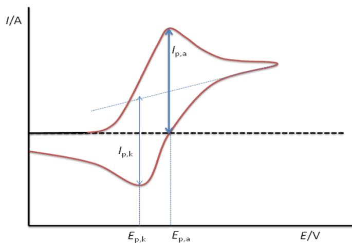
Slika 2.6.2. Ciklički voltamogram za reverzibilni elektroredni proces.
