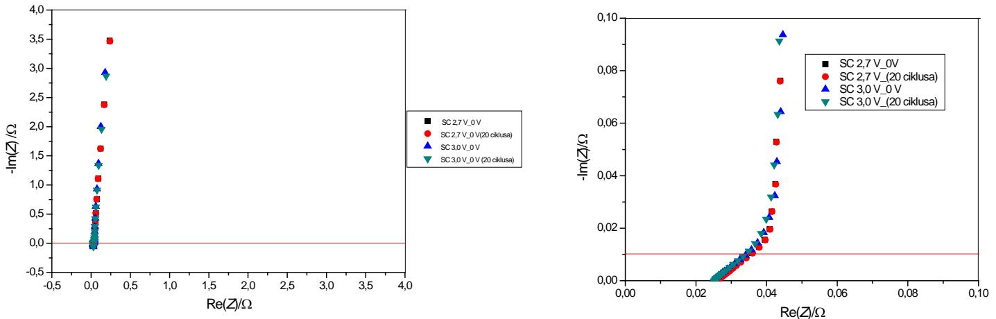
**Slika 5.8.** Usporedba Nyquistovih prikaza dva testirana superkondenzatora snimljenih na dc naponu od 0 V (prazan superkondenzator):
