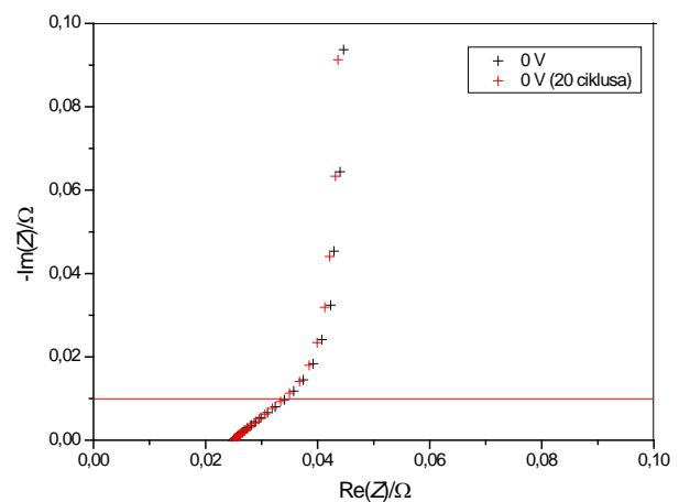
**Slika 5.6.** Usporedba Nyquistovih prikaza za superkondenzator nominalnog napona 3,0 V snimljenih na potencijalu od 0 V (prazan superkondenzator) prije i poslije 20 ciklusa punjenje/praznjnenja konstantnom strujom :
