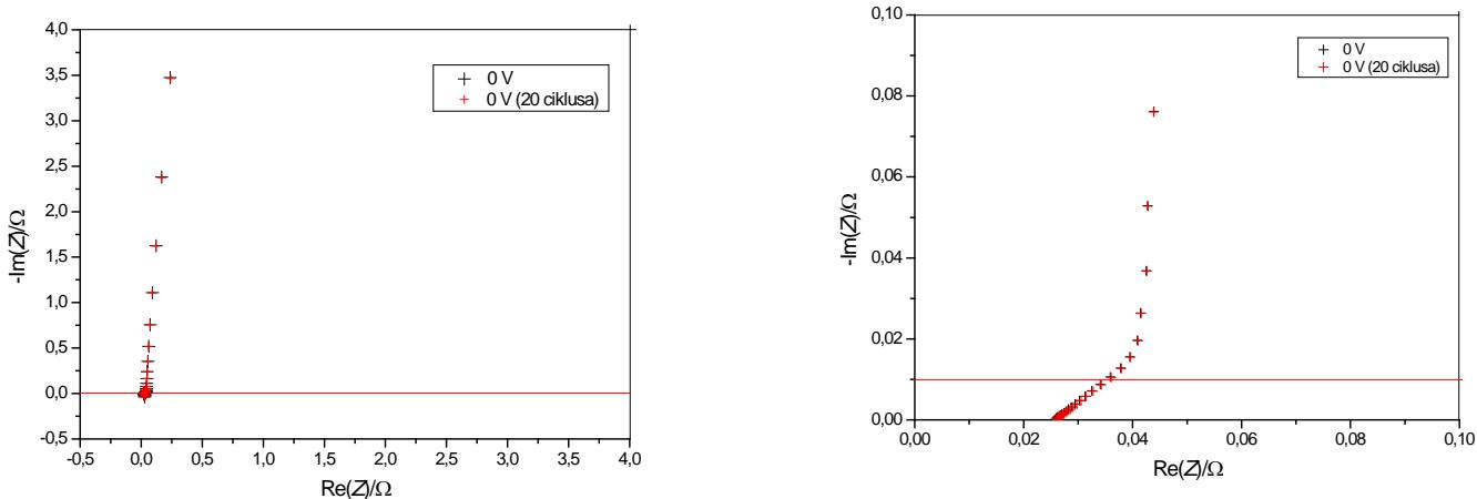
**Slika 5.4.** Usporedba Nyquistovih prikaza za superkondenzator nominalnog napona 2,7 V snimljenih na potencijalu od 0 V (prazan superkondenzator) prije i poslije 20 ciklusa punjenje/praznjenja konstantnom strujom :
