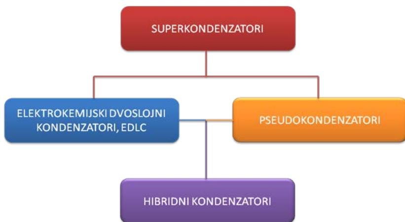
**Slika 2.2.8.** Osnovna podjela superkondenzatora na pseudokondenzatore, hibridne kondenzatore i EDLC.
