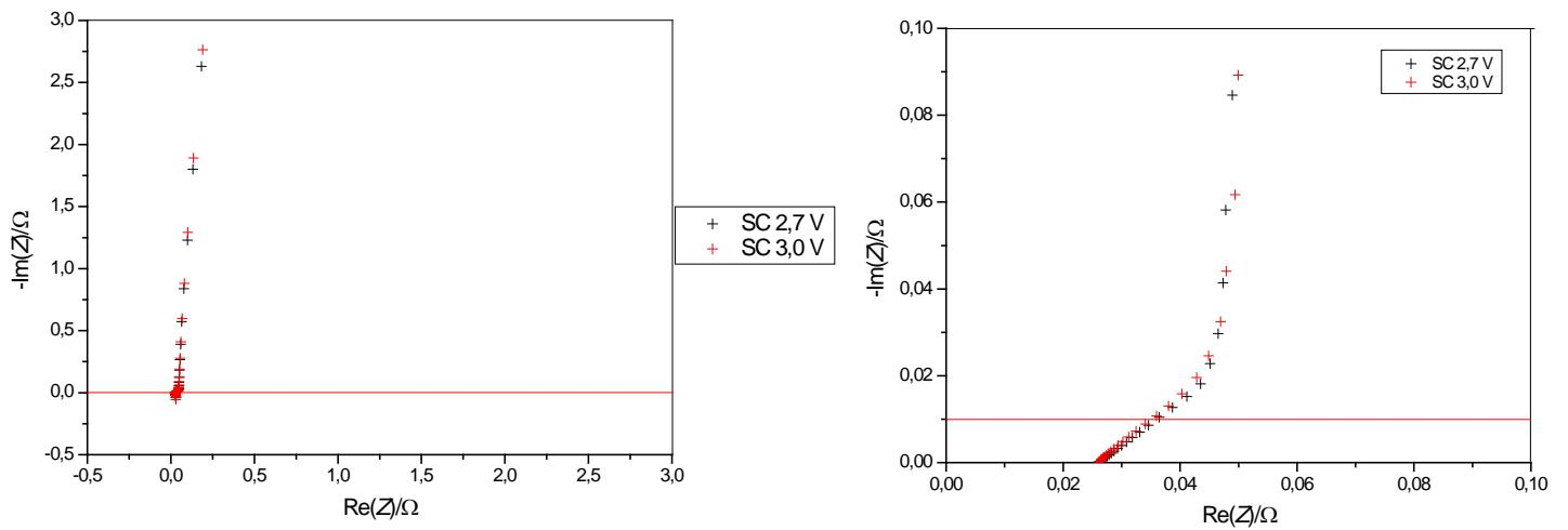
**Slika 5.9.** Usporedba Nyquistovih prikaza dva testirana superkondenzatora snimljenih na dc naponu od 2,7 V (prazan superkondenzator):
