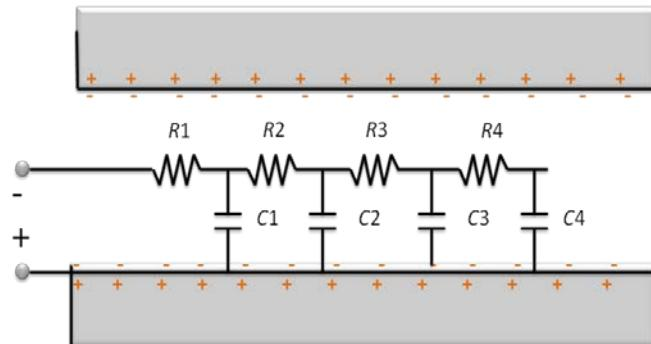
**Slika 5.3.** Shematski prikaz niza otpornika i kondenzatora koji predstavlja ukupni otpor pora elektrode i raspodjelu kapaciteta [18].
