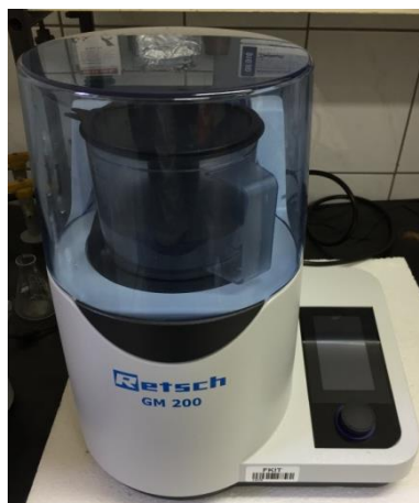
Slika 3.9. Mljevilica za usitnjavanje uzoraka RETSCH, GM 200.
