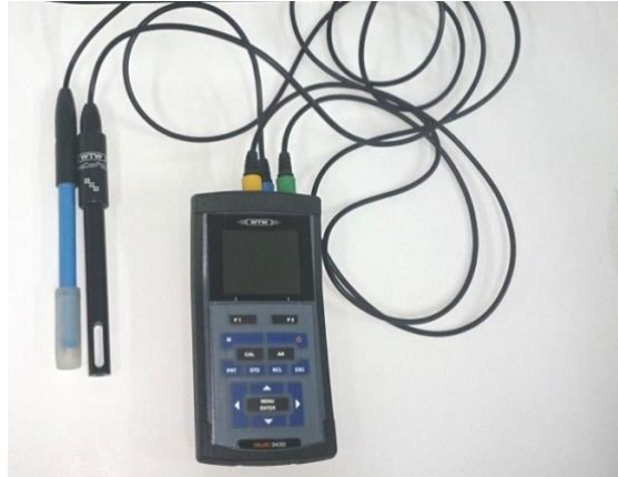
Slika 3.6. Uređaj za mjerenje pH-vrijednosti Multi 340i WTW.
