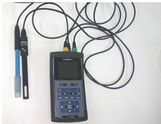
Slika 3.6. Uređaj za mjerenje pH-vrijednosti Multi 340i WTW.
