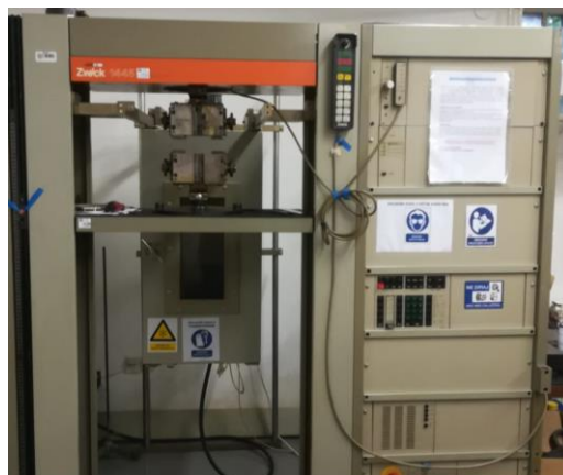
Slika 15. Univerzalna mehanička kidalica Zwick 1445.
