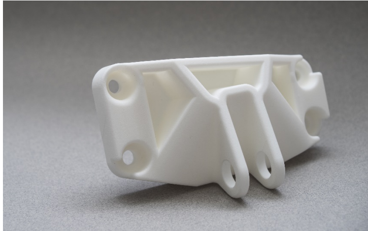
Slika 6. Produkt dobiven SLS procesom 13
