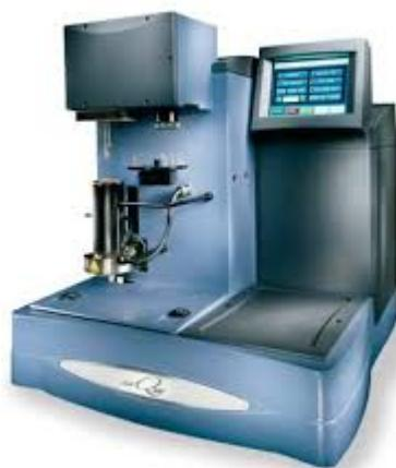
**Slika 18.** Termogravimetar TA Instruments Q 500<sup>22</sup>
