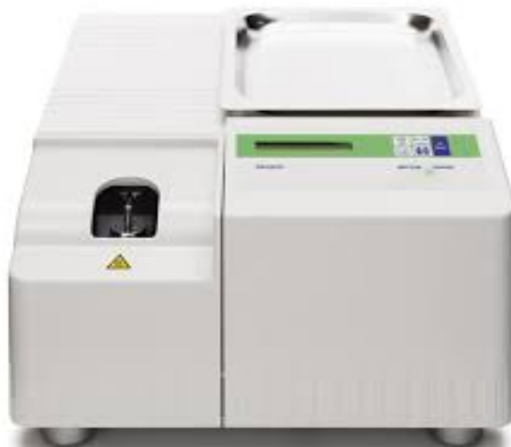
Slika 16. Diferencijalni pretražni kalorimetar Mettler Toledo DSC823e 20
