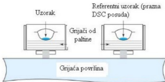
Slika 15. Shematski prikaz rada DCS instrumenta 19
