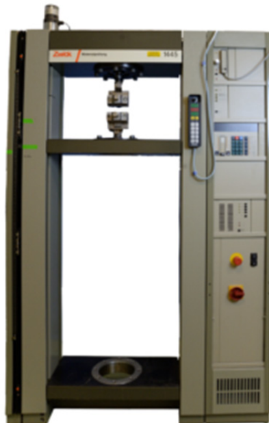
Slika 19. Univerzalna kidalica Zwick 1445 24
