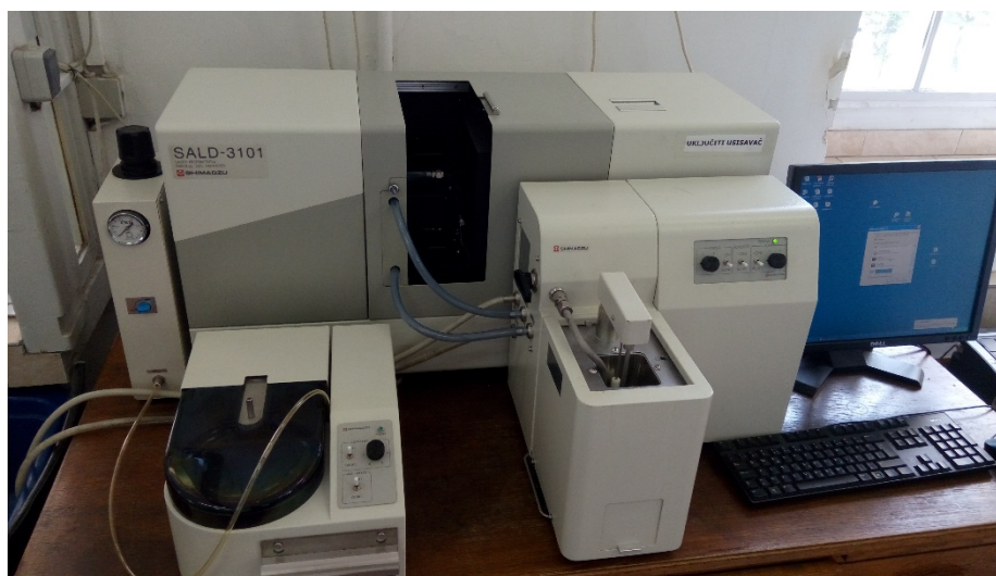
Slika 20. Analizator veličina čestica laserskom difrakcijom Shimadzu Sald 3101 (FKIT)
