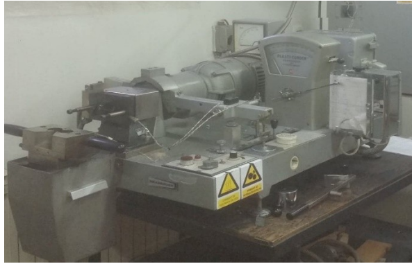
Slika 13. Brabender gnjetalica (FKIT)
