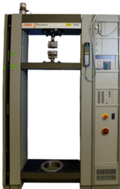
Slika 19. Univerzalna kidalica Zwick 1445 24
