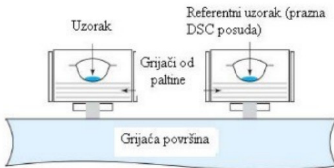
Slika 15. Shematski prikaz rada DCS instrumenta 19
