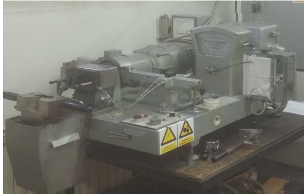
Slika 13. Brabender gnjetalica (FKIT)
