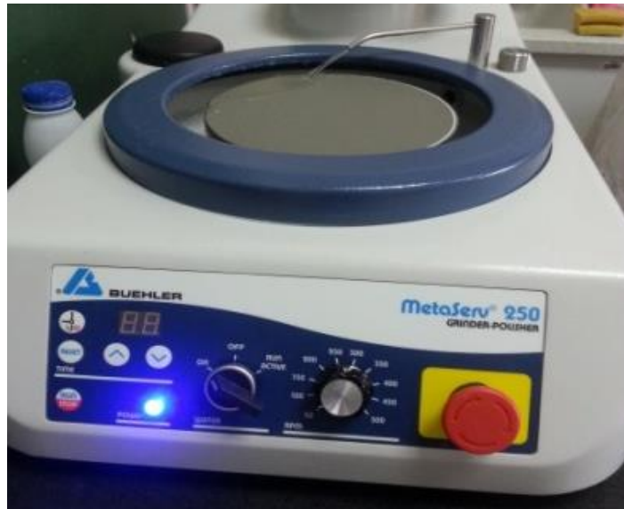
Slika 6. Uređaj za poliranje MetaServ 250, Grinder-Polisher, Buehler
