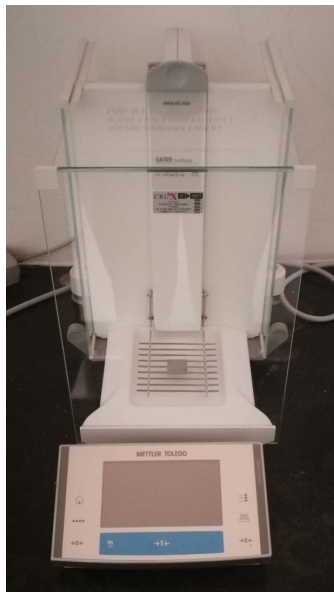
Slika 15 - Analitička vaga Mettler Toledo XA105DU
