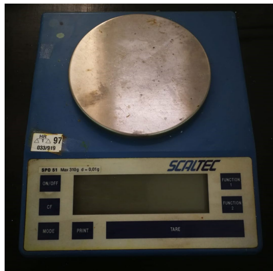
Slika 14 - Digitalna tehnička vaga Scaltec SP0 51
