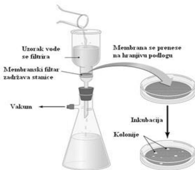
*Slika 3.4.* Metoda membranske filtracije
