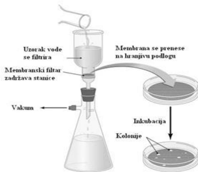
Slika 3.4. Metoda membranske filtracije
