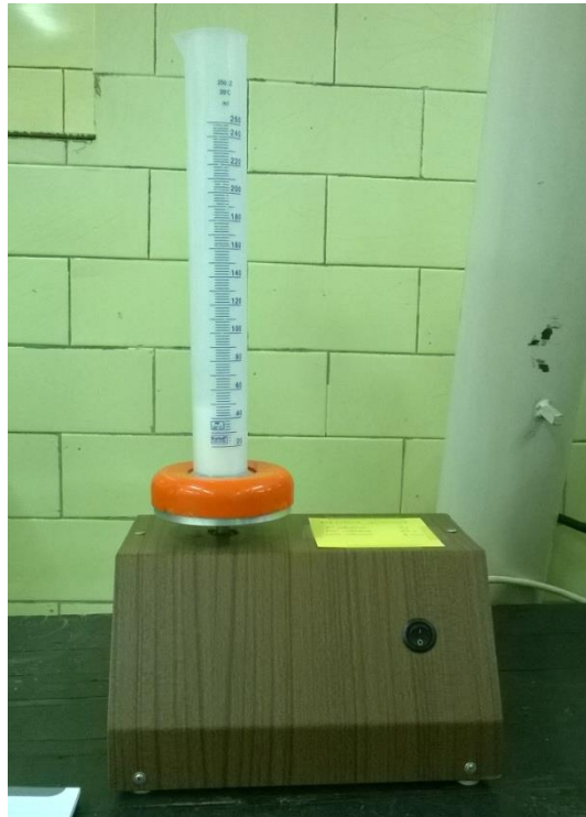
Slika 17. Aparatura za određivanje nasipne gustoće i gustoće nakon potresanja
