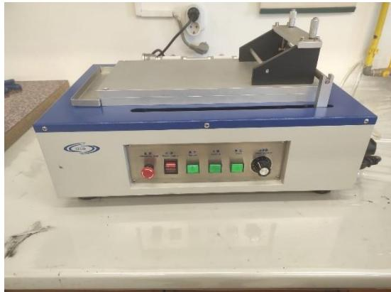
Slika 17. Uređaj za nanošenje premaza
