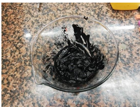
Slika 16. Homogenizirana pasta aktivnog ugljika
