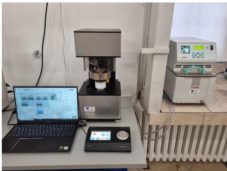
Slika 17. Tenziometar (Dataphysics DCAT 8) i termostat (Julabo CF 31)
