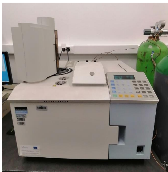
Slika 3.7. Plinski kromatograf opremljen TCD detektorom
