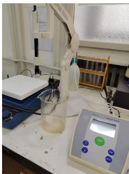
Slika 11. pH-metar Mettler Toledo S20 SevenEasy, Švicarska
