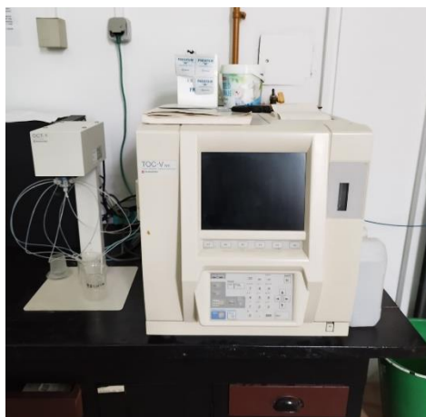
Slika 13. TOC-Vws analizator Shimadzu, Kyoto, Japan
