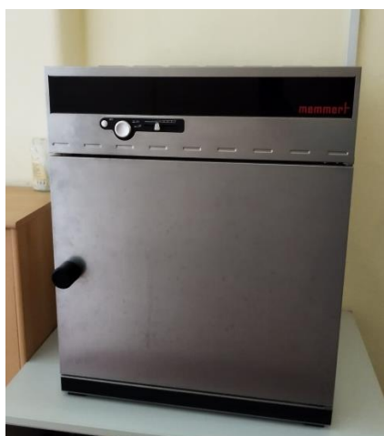
Slika 8. Sušionik Memmert UNB 100, Schwabach, Njemačka
