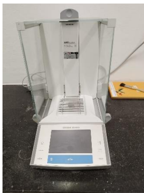
Slika 7. Analitička vaga Mettler Toledo, XA105, Švicarska
