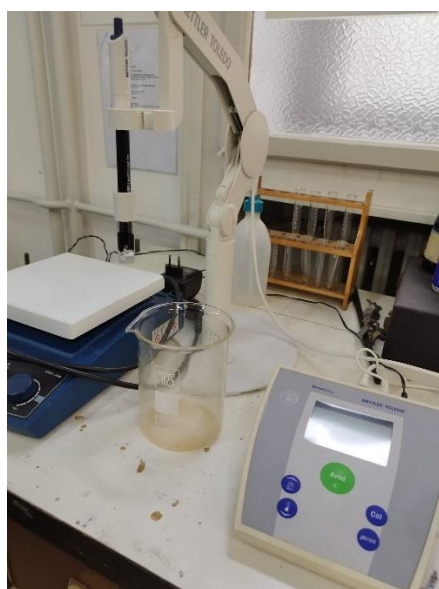
Slika 11. pH-metar Mettler Toledo S20 SevenEasy, Švicarska
