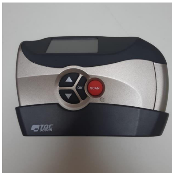
Slika 16 Uređaj za mjerenje sjaja premaza
